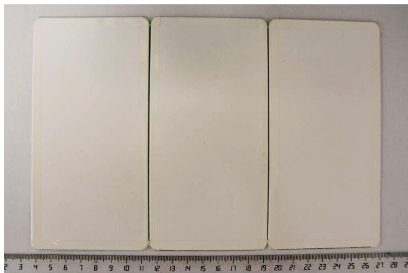
Figura 7. Aspecto de las muestras tras 240 horas de condensación continua (Ref. 7060 + 7240 (20, 23 y 28): de izquierda a derecha)
