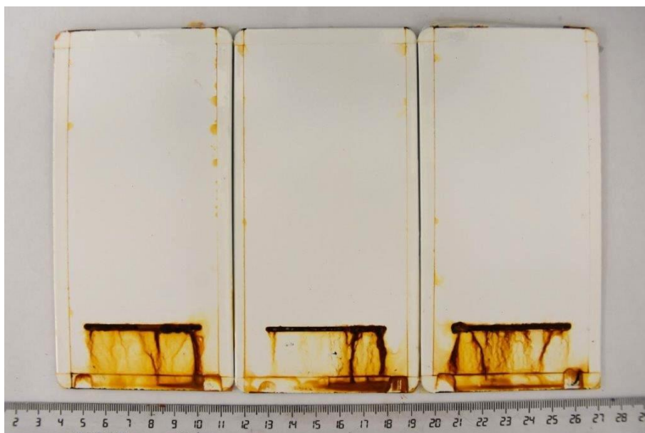
Figura 4. Aspecto de las muestras tras 480 horas de niebla salina (Ref. 7060 + 7240 (19, 24 y 25): de izquierda a derecha)
