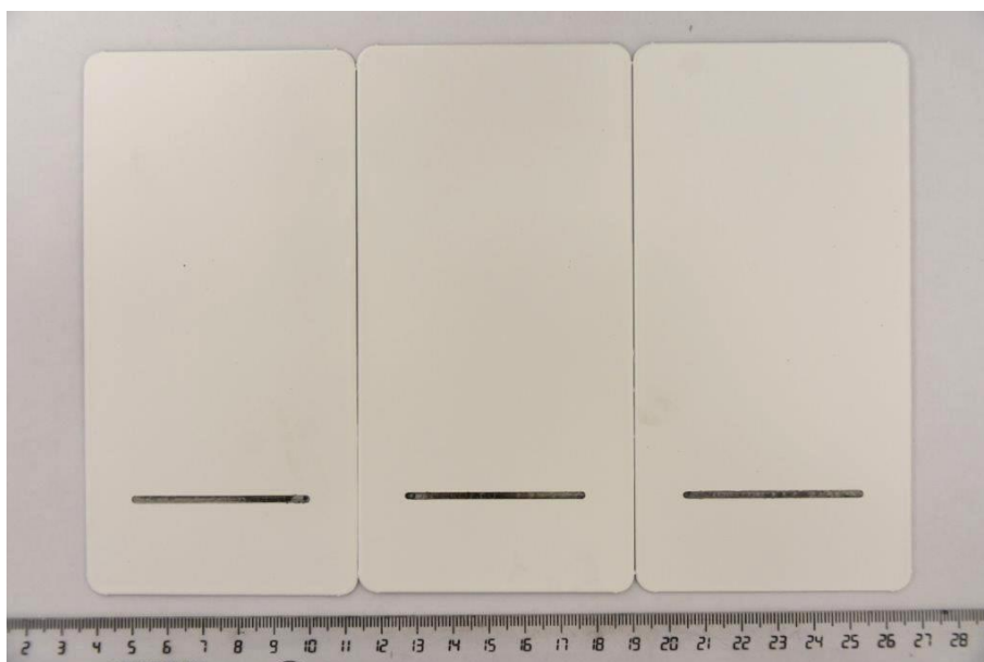
Figura 2. Muestras con entalla artificial previa al ensayo de niebla salina (Ref. 7060 + 7240 (19, 24 y 25): de izquierda a derecha)
