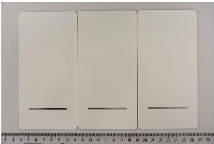
Figura 2. Muestras con entalla artificial previa al ensayo de niebla salina (Ref. 7060 + 7230 (10, 11 y 14): de izquierda a derecha)
