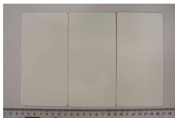
Paneles para el ensayo de condensación de agua (Ref. 7060 + 7230 (12, 13 y 18): de izquierda a derecha)
