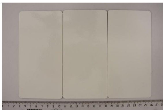
Paneles para adherencia en recepción (Ref. 7060 + 7230 (15 a 17): de izquierda a derecha)
