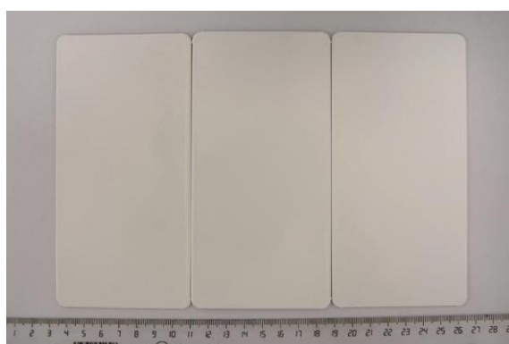
Paneles para el ensayo de niebla salina (Ref. 7060 + 7210 (5 a 7): de izquierda a derecha)
