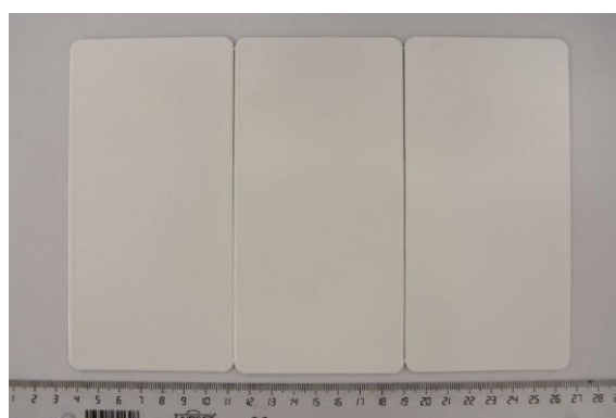
Paneles para el ensayo de condensación de agua (Ref. 7060 + 7210 (4, 8 y 9): de izquierda a derecha)
