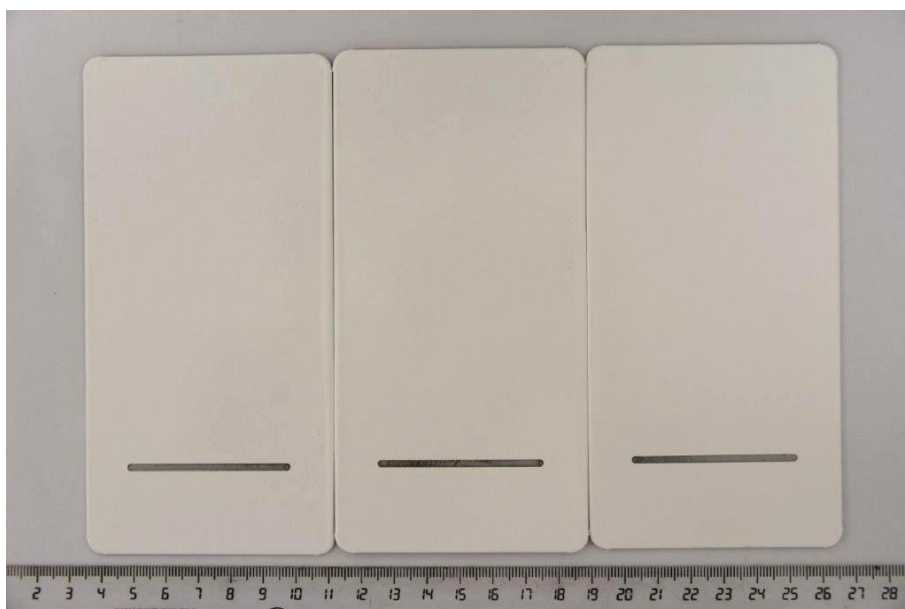
Figura 2. Muestras con entalla artificial previa al ensayo de niebla salina (Ref. 7060 + 7210 (5 a 7): de izquierda a derecha)
